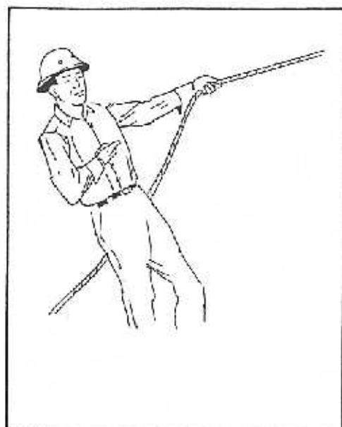
RITIRO DEL BRACCIO: (braccio telescopico): segnale con una mano. Un pugno resta davanti al petto, il pollice è puntato all'infuori e la parte posteriore del pugno batte sul petto.
